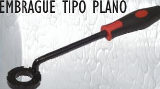
Para el trabajo del embrague al engranaje interno, utilice esta herramienta para evitar el embrague Rotación mientras se aprietan los engranajes o tuercas interiores
