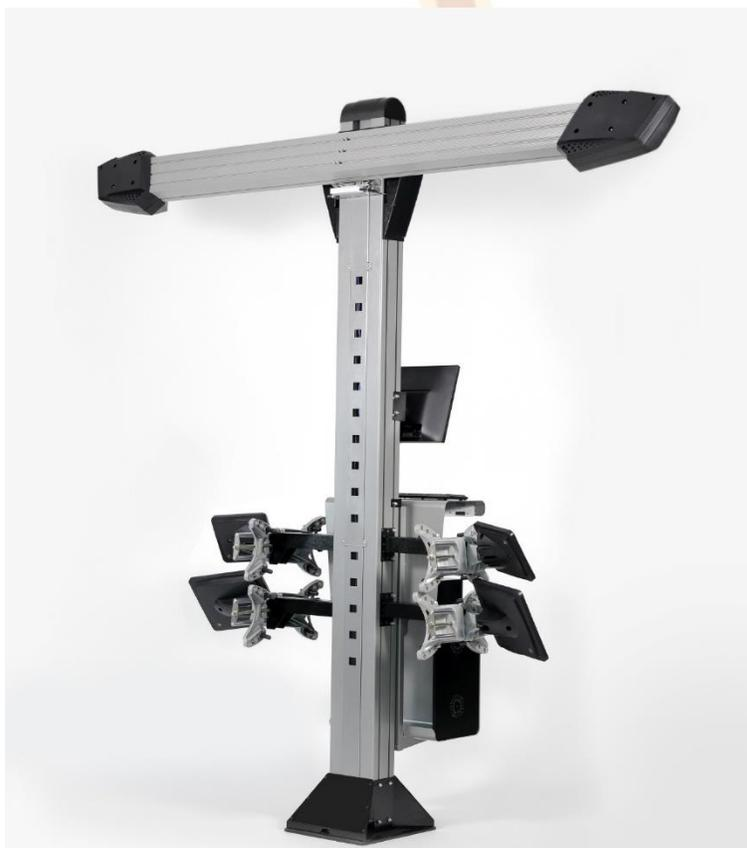
**La Máquina de alineación 3D TECHNO VECTOR cuenta con Cámaras de capacidad Gran Angular de 60° y lectura hasta 15mts...**
