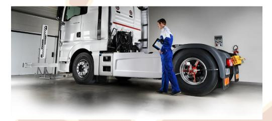
También algunas marcas de camiones y de vehículos comerciales necesitan un equipo adecuado para la correcta calibración de los sistemas de asistencia a la conducción, como las tele cámaras, radares o sensores que gestionan el Adaptive Cruise Control.
