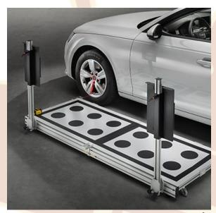
2- CCS, EL KIT MULTIMARCA PARA LA CALIBRACIÓN DE LAS TELE CÁMARAS
