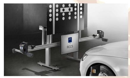
Es la solución completa y profesional que TEXA ha puesto a punto para el mundo de los carroceros y de los talleres multimarca, para la calibración de sensores, cámaras y radares ADAS. En conjunto con un equipo de diagnóstico profesional TEXA compatible.
