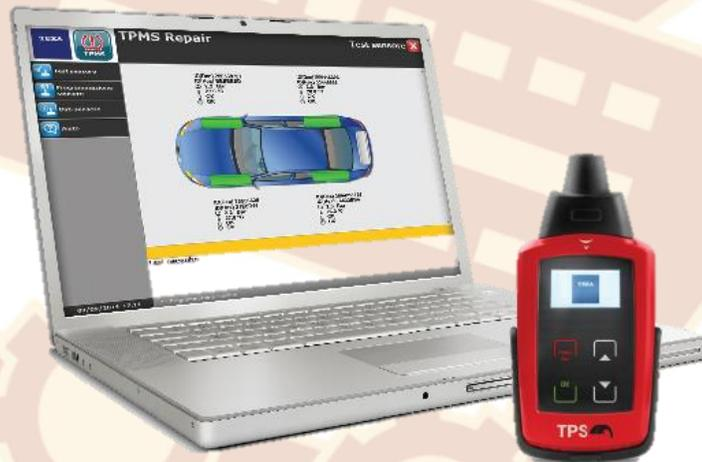
Con la ayuda de la APP gratuita "TPMS Repair", que guía al usuario paso a paso a través de todas las fases de trabajo, y gracias al módulo Bluetooth integrado, TPS es capaz de conectarse con cualquier PC que tenga instalado el software IDC5 TEXA, o bien con AXONE 5.
