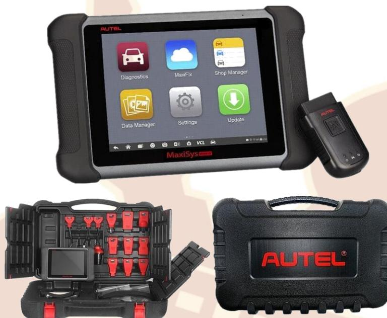
Está basado en el Sistema operativo Android y se caracteriza por tener una mejor cobertura de diagnósticos de nivel OE y capacidad de codificación de ECU. Construido con un procesador core-6 Exynos 5260 (1.3 GHz quad-core ARM Cortex-A7 + 1.7 GHz dual-core ARM Cortex-A15), pantalla táctil HD de 8", y comunicación inalámbrica de larga distancia, eficientemente un diagnóstico y análisis comprensivo del vehículo.
