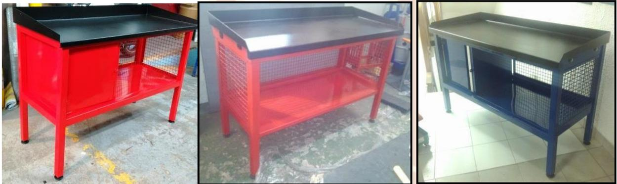
Fabricación metálica para trabajo pesado en tubería estructural, mesón principal con aletas laterales según modelo estándar, soportada sobre niveladores de trabajo pesado, entrepaño inferior, laterales con malla.
