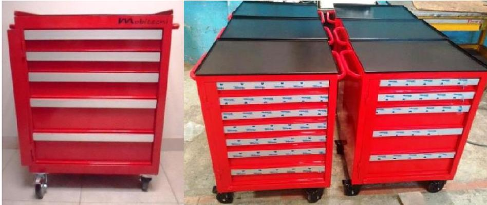
Fabricación totalmente metálica en lámina CR C 20, tapa superior tipo mesón, soportado sobre cuatro ruedas de 4"; dos con freno de giro y freno de rueda y dos giratorias, correderas extensibles de trabajo pesado con suave movimiento, una manija lateral, sintético protector en cada una de las gavetas. Cierre con platina frontal para colocar candado, acabado general en pintura electrostática a un color.
