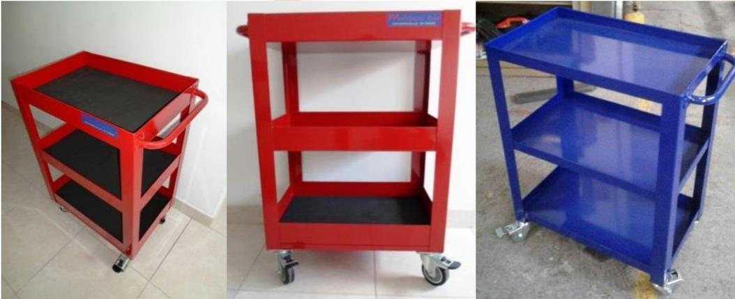
Fabricación totalmente metálica; parales en lámina CR C 16 y las bandejas en CR C 20 pestañas de 3 cms, para trabajo semi-pesado, soportado sobre ruedas de 3"; dos con freno de giro y freno de rueda y dos giratorias, sintético protector en cada bandeja, una manija al costado, acabado general en pintura electrostática a un color.
