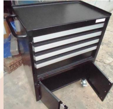
Fabricación totalmente metálica en lámina CR C 20, tapa superior en C:18, soportado sobre ruedas de 4" con freno de giro y freno de rueda, correderas extensibles de trabajo pesado y suave movimiento, sintético protector en cada una de las gavetas, cajuela inferior con dos puertas, manijas en aluminio, cierre con platina frontal para colocar candado, acabado general en pintura electrostática a un color.
