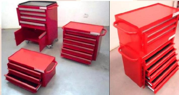
Cajoneras de fabricación totalmente metálica en lámina CR C 20, con correderas extensibles de trabajo pesado y suave movimiento, sintético protector en cada una de las gavetas, manijas laterales, cierre con platina frontal para colocar candado, acabado general en pintura electrostática a un color.
