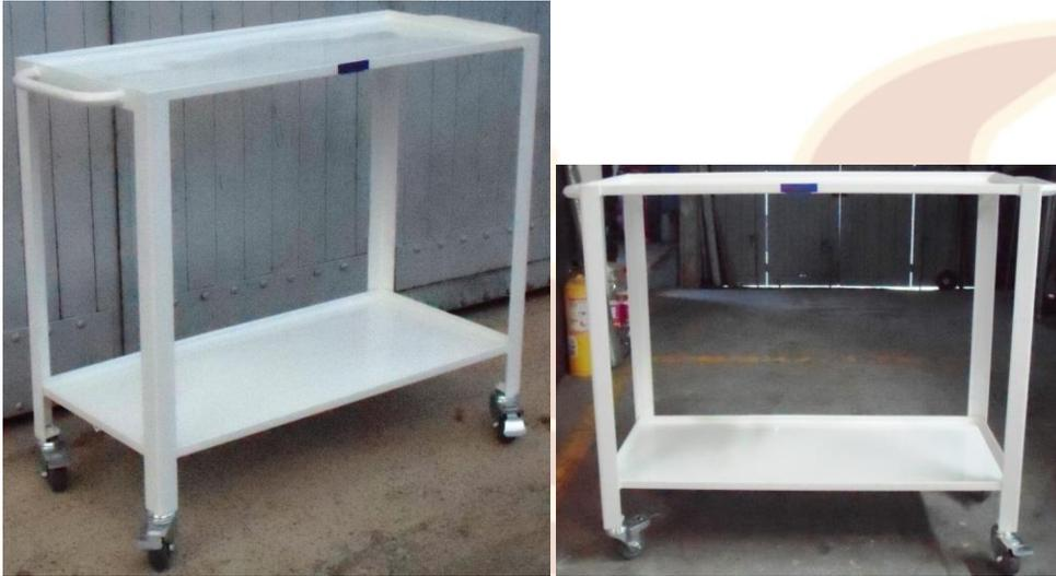
Fabricación totalmente en lámina; estructura en lámina Cold Rolled, dos bandejas con pestañas de tres centímetros de alto, dos manijas laterales en tubo redondo, soportado sobre ruedas de 3" con freno de giro y freno de rueda, acabado general en pintura electrostática a un color.
