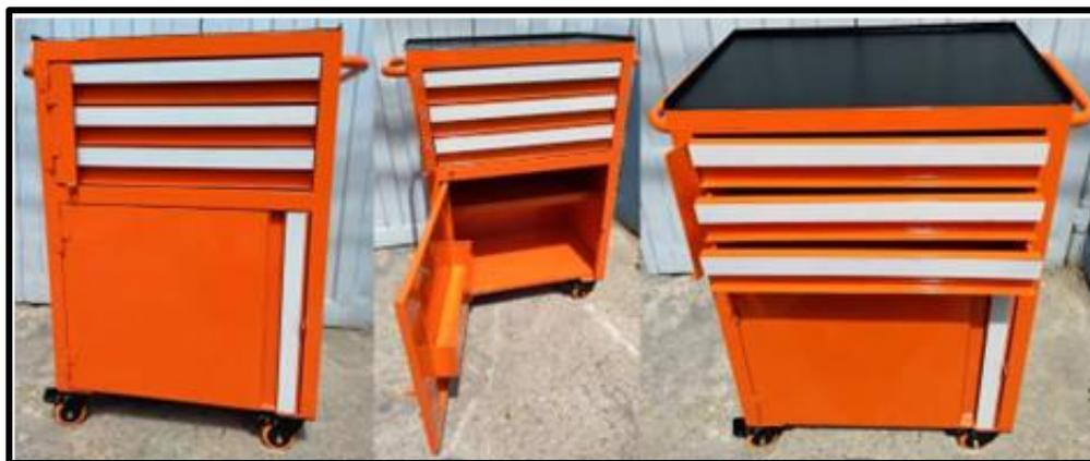
Fabricación totalmente metálica en lámina CR C 20, tapa superior plan tipo mesón, soportado sobre cuatro ruedas de 3"; dos con freno de giro y freno de rueda y dos giratorias, correderas extensibles de trabajo pesado con suave movimiento, una manija lateral, sintético protector en cada una de las gavetas. Cierre con platina frontal para colocar candado, acabado general en pintura electrostática a un color (asignado por el cliente).
