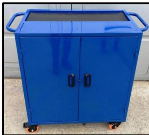
Estante móvil con tablero perforado para colocar herramientas con ganchos rack, tapa superior como banco de trabajo y compartimiento interno para equipos y partes. Soportado sobre cuatro ruedas de 4" giratorias con freno en poliuretano de alta resistencia, manijas laterales para su manipulación, dos puertas frontales con porta candado, para brindar seguridad.
