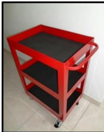
Fabricación totalmente metálica; parales en lámina CR C 16 y las bandejas en CR C 20 pestañas de 3 cms, para trabajo semi-pesado, soportado sobre ruedas de 3"; dos con freno de giro y freno de rueda y dos giratorias, sintético protector en cada bandeja, una manija al costado, acabado general en pintura electrostática a un color.
