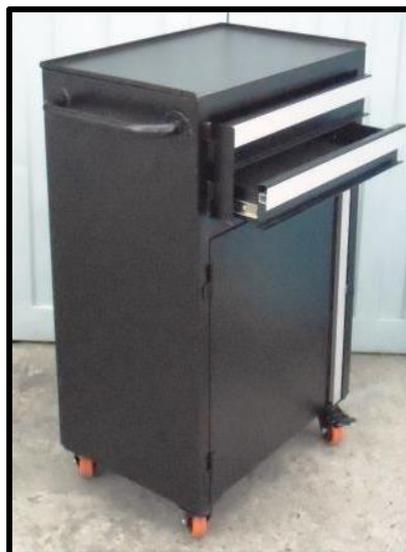
Fabricación totalmente metálica en lámina CR C 20, tapa superior tipo bandeja, soportado sobre cuatro ruedas de 3"; dos con freno de giro y freno de rueda y dos giratorias, correderas extensibles de trabajo pesado y suave movimiento, sintético protector en cada una de las gavetas,
