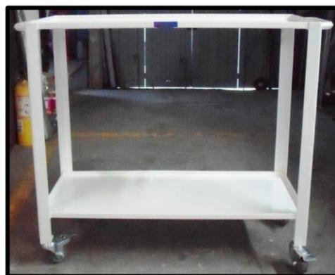
Fabricación totalmente en lámina; estructura en lámina Cold Rolled, dos bandejas con pestañas de tres centímetros de alto, dos manijas laterales en tubo redondo, soportado sobre ruedas de 3" con freno de giro y freno de rueda, acabado general en pintura electrostática a un color.
