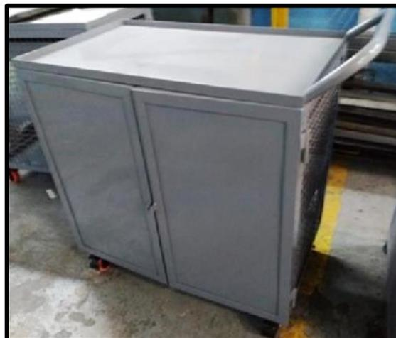
Fabricación totalmente metálica en lámina CR C 20, una gaveta interna correderas extensibles de trabajo pesado y suave movimiento, tapa superior tipo bandeja, soportado sobre cuatro ruedas de 3" con freno de giro y freno de rueda, puerta frontal, manijas frontales en plástico, cierre con porta candado, acabado general en pintura electrostática a un color.
