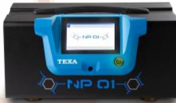
La medición de la concentración del número de partículas en los gases de escape de los vehículos de motor se ha vuelto muy importante recientemente en varios países europeos y se integra a la legislación PTI de los Países Bajos Bélgica y Alemania las técnicas de detección basadas en carga para el examen de Nano Partículas como la carga por difusión (DC) representan la principal tecnología disponible para este tipo de verificación.
